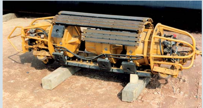
Die hydraulische Innenzentrierung , hier im Bild, wird gern eingesetzt, denn das Schweißen der Naht von außen ohne Behinderung durch eine Außenzentrierung zählt als äußerst wirtschaftlich.
