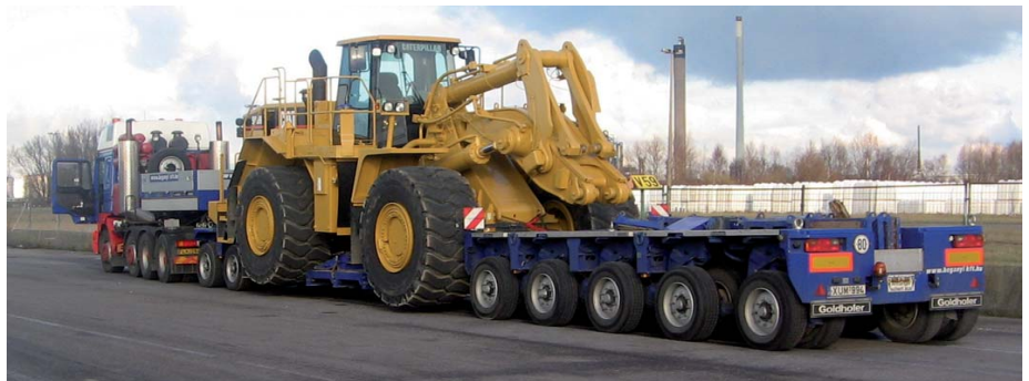
Mit dem Schwerlast-Kompaktsystem XLE von Goldhofer werden auch große Baumaschinen sicher transportiert. (Foto: Goldhofer)
