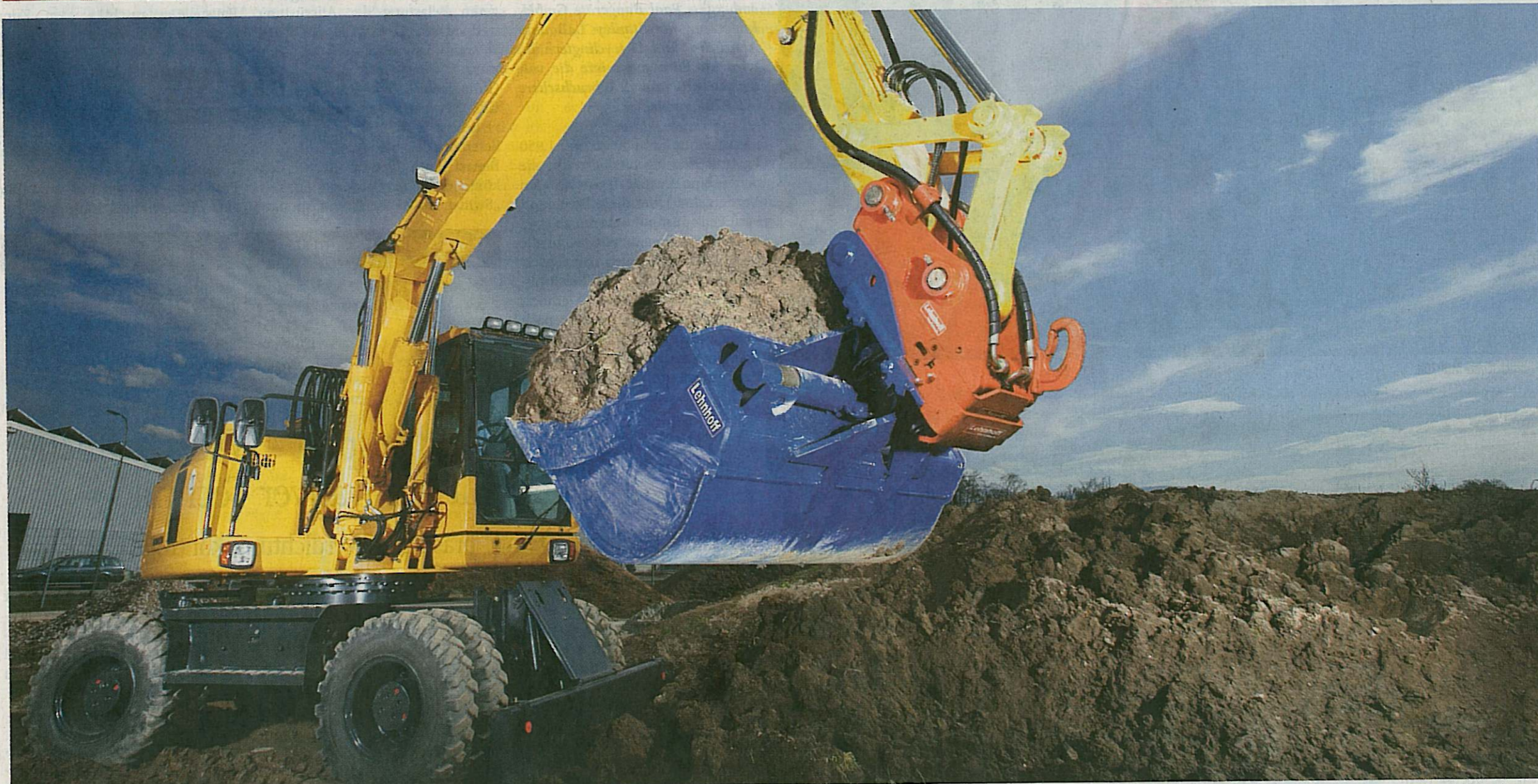
Der Schwenk-Tieföffel Lehnhoff HB20 und der vollhydraulische Schnellwechsler Lehnhoff Variolock VL100 für Bagger zwischen 10 und 19 Tonnen bieten höchste Effizienz auf der Baustelle.
